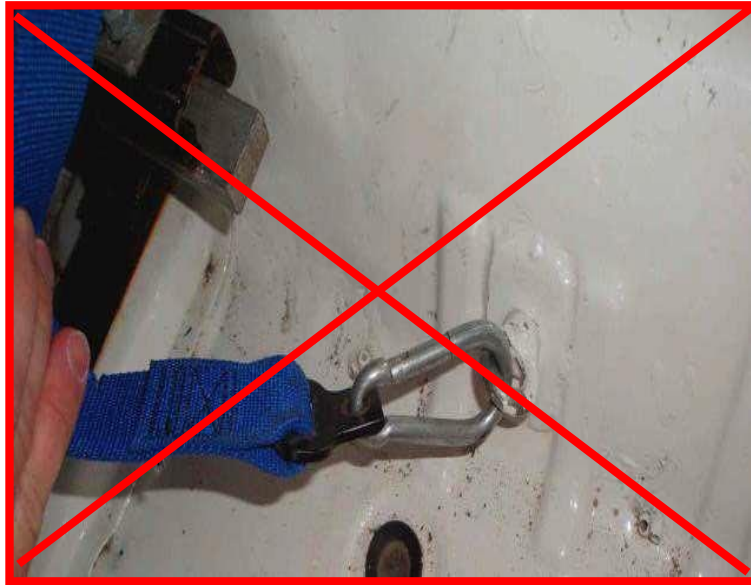
Karabijnhaak niet toegestaan voor montage gordel.
