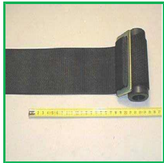
Figuur 2: goed de gesp zit tegen gordelbuis Waardoor verschuiven van gesp niet Meer mogelijk is.
